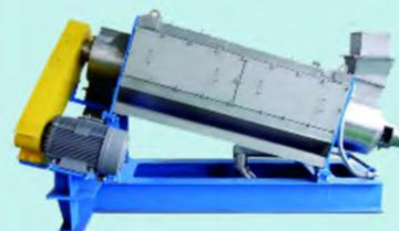
■ 摩擦清洗机 Friction Washer
